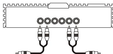
2 канала + 1 канал (мостовой режим)
