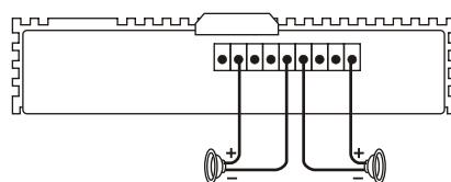
2 канала + 1 канал (мостовой режим)
