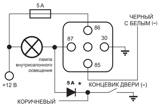
\* Дополнительный развязывающий диод (устанавливается при необходимости).
