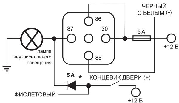
\* Дополнительный развязывающий диод (устанавливается при необходимости).
